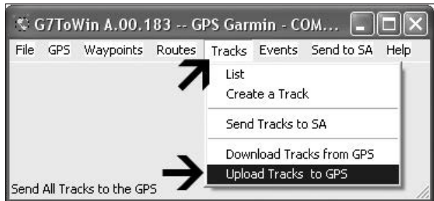
Bild 4: G7ToWin – Tracks und Waypoints zum GPS-Empfänger übertragen
